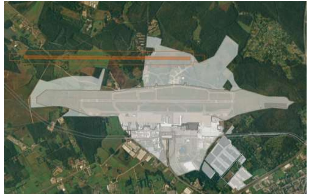
Attēls 90 – Atšķirīga garuma atkarīga paralēlo skrejceļu sistēma Avots: "Ineco"
