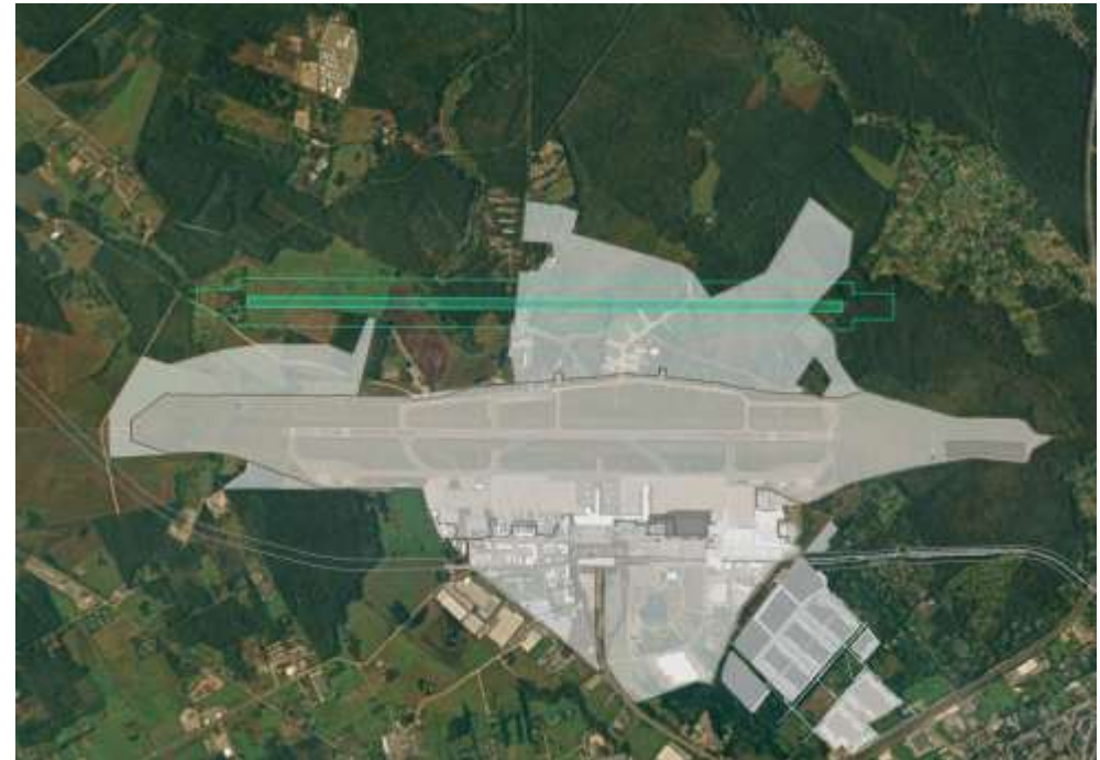
Attēls 86 –Nošķirta paralēlo skrejceļu sistēma. Avots: "Ineco"
