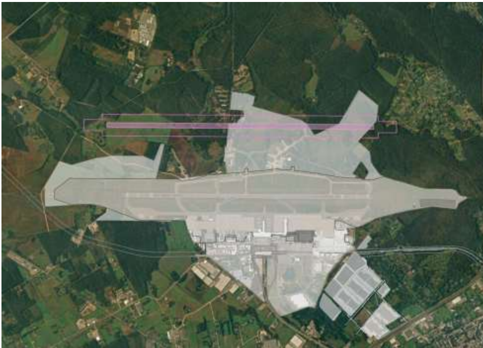
Attēls 87 – Atkarīga paralēlo skrejceļu sistēma Avots: "Ineco"
